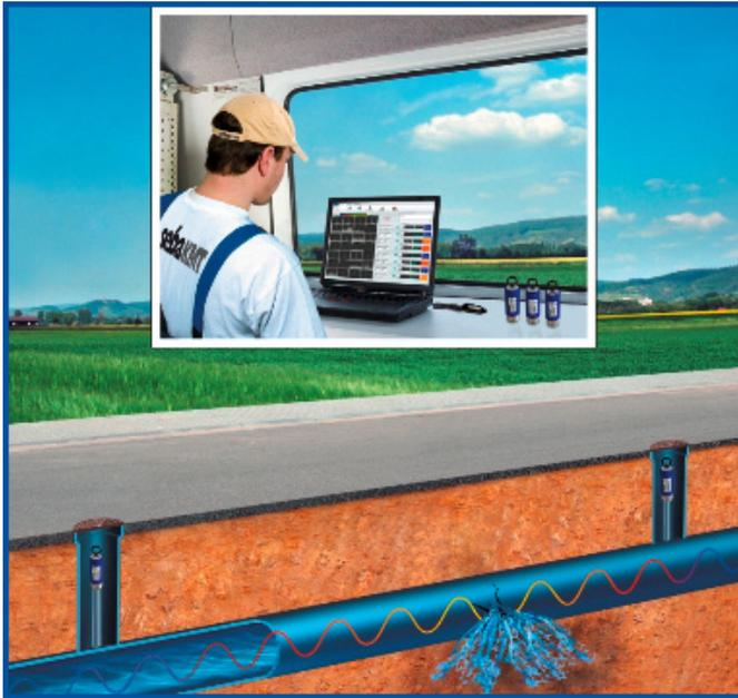
**DIE SENSOREN MESSEN EIGENSTÄNDIG UND WURDEN NACH DER MESSUNG AUSGELESEN. DIESES PRINZIP GILT FÜR BEIDE MESSMETHODEN DES SEBALOG CORR**
