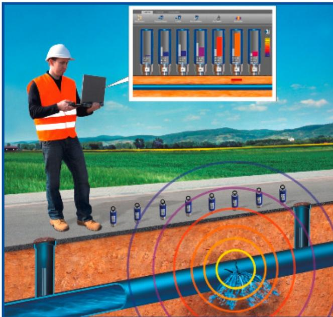
**DIE SENSOREN ÜBERMITTELN WÄHREND EINER PUNKTORTUNG DEN GERÄUSCHPEGEL, DIE FREQUENZ UND DEN ESA WERT PER FUNK UND IN ECHTZEIT ZUM ANWENDER. WIE MIT EINEM BODENMIKROFON KANN SO DIE POSITION DER LECKAGE PUNKTGENAU BESTIMMT WERDEN.**
